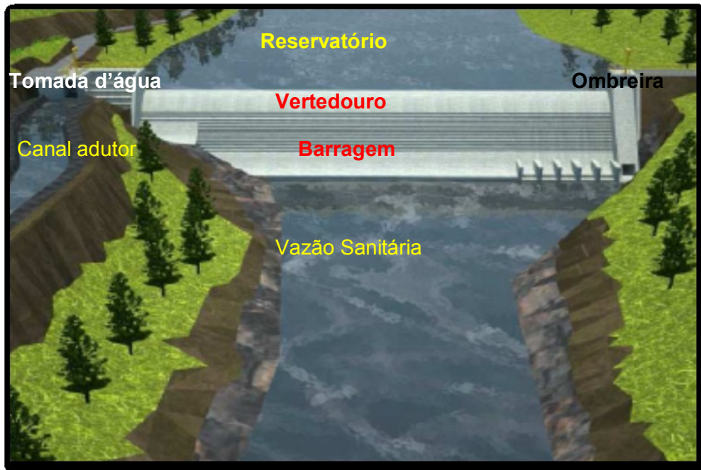
Figura 2.2 – Exemplo esquemático de barramento a ser implantado, podendo ser visualizado o vertedouro e tomada d'água pela margem direita do rio.
