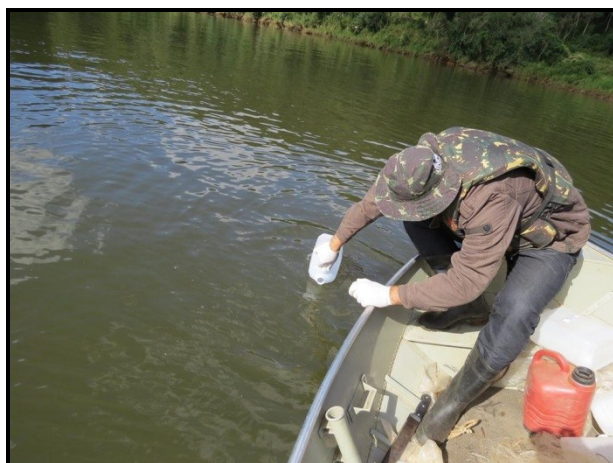
Figura 3.11 – Procedimento de coleta de amostra para análise físico-química.
