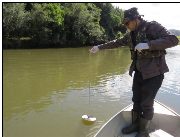
Figura 3.13 – Medição da profundidade e transparência, com apoio de disco de Secchi.
