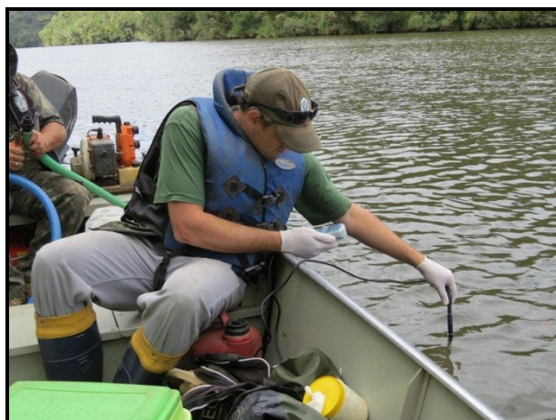
Figura 3.9 – Mensuração dos níveis de oxigênio dissolvido, saturado e temperatura da água.
