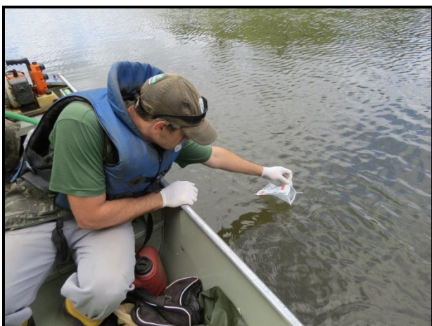
Figura 3.10 – Procedimento de coleta de amostra para análise microbiológica.
